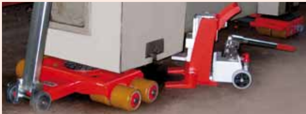
Kugelgelagerte Rollen garantieren einen leichten Lauf Castors with ball bearings guarantee easy movement
