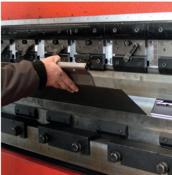
Das Abkanten erfolgt mit unserer leistungsfähigen Abkantpresse, die Kantlängen bis zu 3 m bewältigen kann. Neben den genannten Bearbeitungsschritten sind selbstverständlich auch weitere Arbeitsschritte wie Bohren, das Einsetzen von Nieten und Verschweißen möglich.
